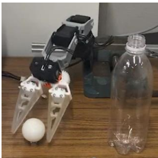
ソフトハンド付ロボットアーム (ハンドは3Dプリンタ製作)
